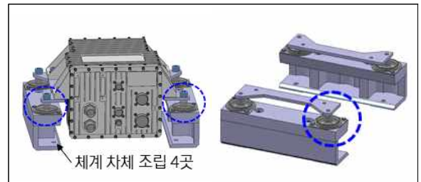
[그림 1] 전차 관성항법장치 형상 및 마운트
